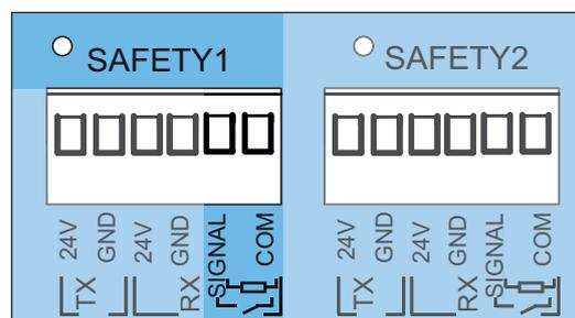
Fig. Collegamento a SAFETY 1
