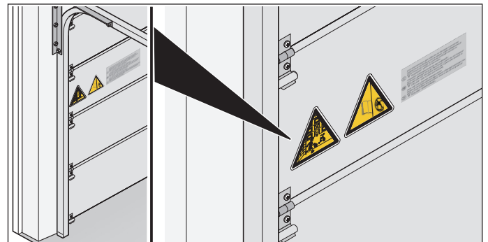
Fig. 1.2 Colocar el adhesivo en la hoja de la puerta
