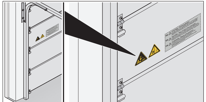
Afb. 1.2 Sticker op deurblad aanbrengen
