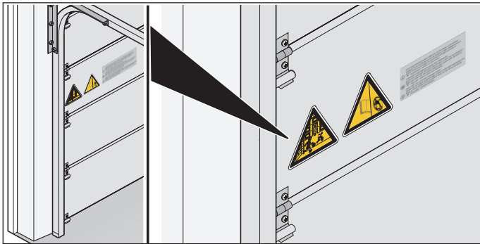
Bild 1.2 Sätt dekal på portbladet
