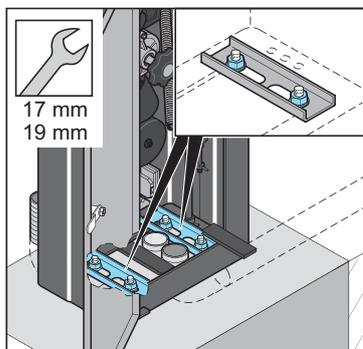
4. Serrer 4 écrous selon les directives du fabricant d'ancrage à haute résistance.
