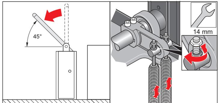
7. Positionner la lisse manuellement ou via le bouton de déverrouillage d'urgence en formant un angle de 45° et la maintenir dans cette position.
