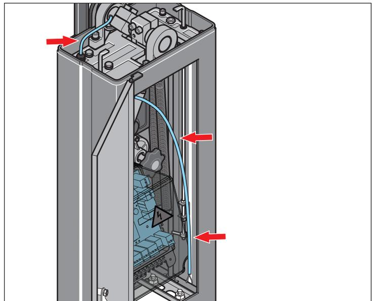
5. Faire passer le câble dans le caisson par le raccord à vis de la plaque de base.
