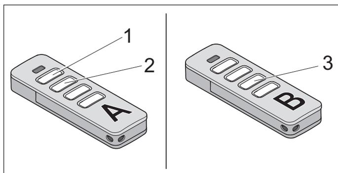
1. Appuyer sur les touches 1 et 2 d'un émetteur portatif programmé (A) pendant 3 à 5 secondes jusqu'à ce que la LED de l'émetteur portatif s'allume brièvement.
