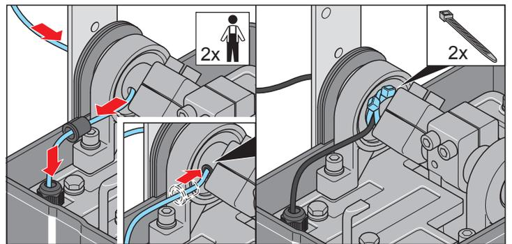
4. Poser le câble comme dans l'illustration et le fixer à l'arbre avec 2 serre-câble se croisant.
