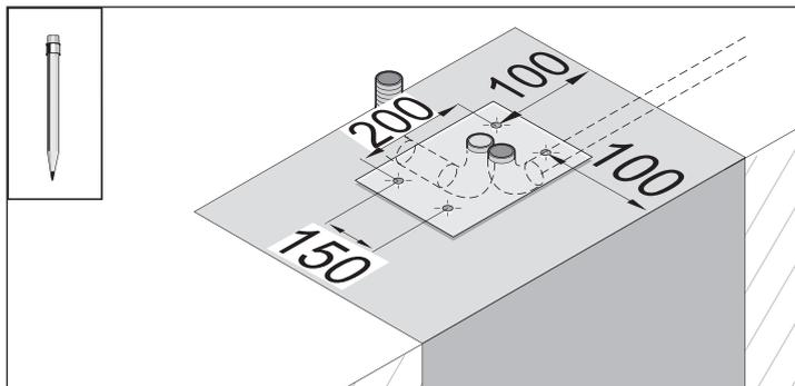
2. Mesurer les perçages à effectuer dans les fondations et les tracer.
