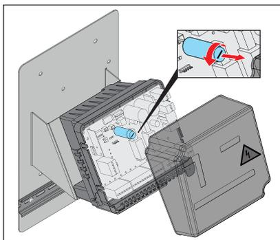
4. Remplacer le fusible défectueux (fusible 1 A rapide).
