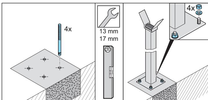
5. Placer les ancrages à haute résistance dans les trous.
