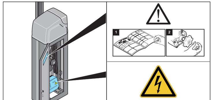
L'installateur / l'exploitant doit poser les panneaux d'avertissement suivants :
