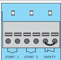
**Borne de raccordement, 6 pôles START 1, START 2 et SAFETY**
