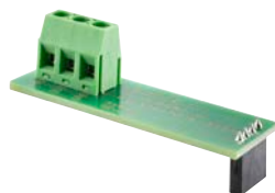
Output OC Salida de colector abierto
