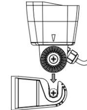
1. Afloje el tornillo largo del sensor. No es necesario quitar el tornillo completamente.
