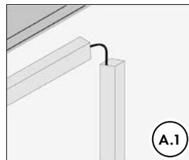
Con nuestro canal de cableado, soporte adhesivo y el correspondiente material de montaje, es posible asegurar el cableado y fijación. p. ej.: sobre la hoja de la puerta, en la pared, en el marco de la puerta.
