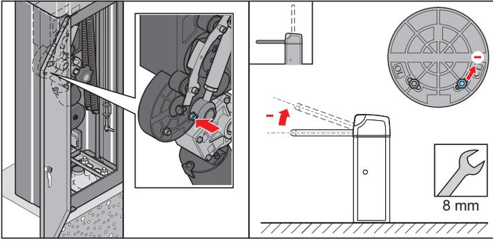
4. Pour régler la **position de fin de course inférieure (CL)**, dévisser l'écrou (ouverture de clé 8) et pousser dans les trous oblongs.
