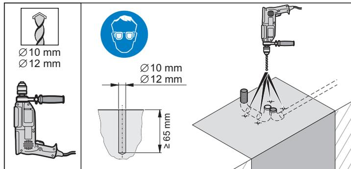
3. Percer 4 trous de Ø 10 ou Ø 12 mm à au moins 65 mm de profondeur.
