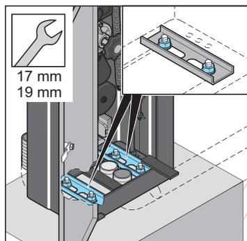
4. Serrer 4 écrous selon les directives du fabricant d'ancrage à haute résistance.
