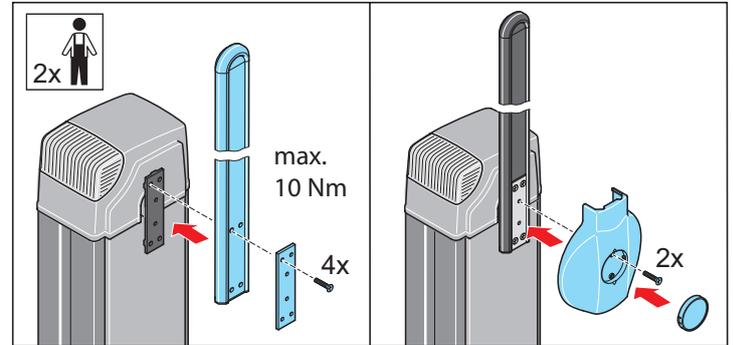
2. Placer la lisse sur le support de lisse, placer la cale de blocage et serrer à l'aide de 4 vis.
