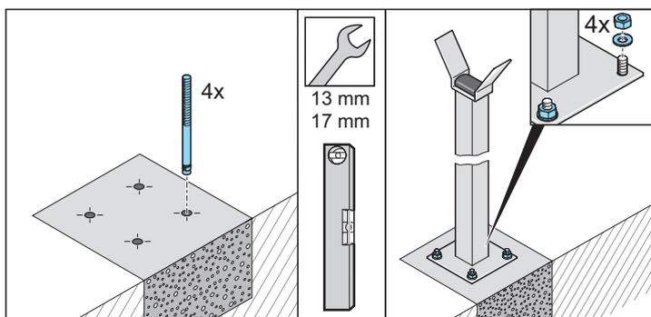
5. Placer les ancrages à haute résistance dans les trous.
