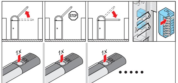
Émetteur d'ordre 1 : ouverture - arrêt - fermeture - arrêt - ouverture - arrêt - ...
