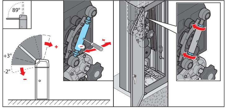
4. Insérer un tournevis dans l'alésage du tendeur. Tourner le tendeur.
