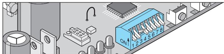
Pour commuter les divers interrupteurs DIP, utiliser un petit tournevis.
