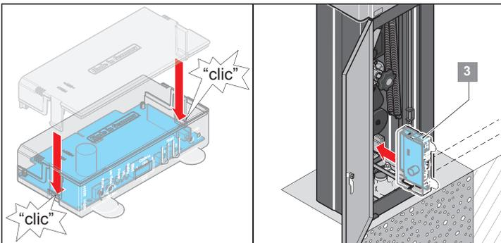
5. Fermer le boîtier de commande et monter la commande (3).
