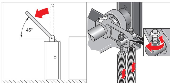
7. Positionner la lisse manuellement ou via le bouton de déverrouillage d'urgence en formant un angle de 45° et la maintenir dans cette position.
