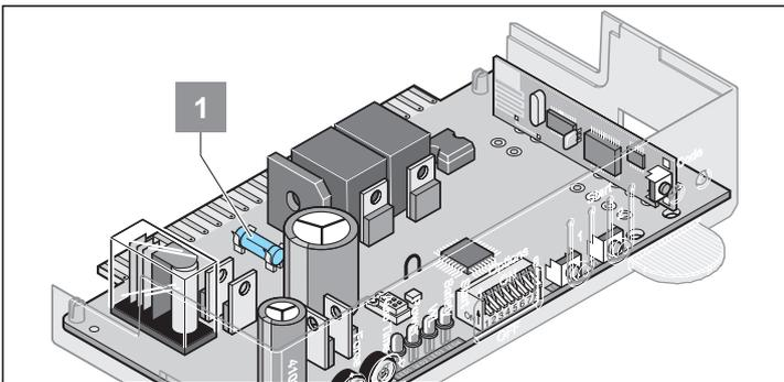
4. Remplacer le fusible défectueux (1) (fusible 1 A rapide).
